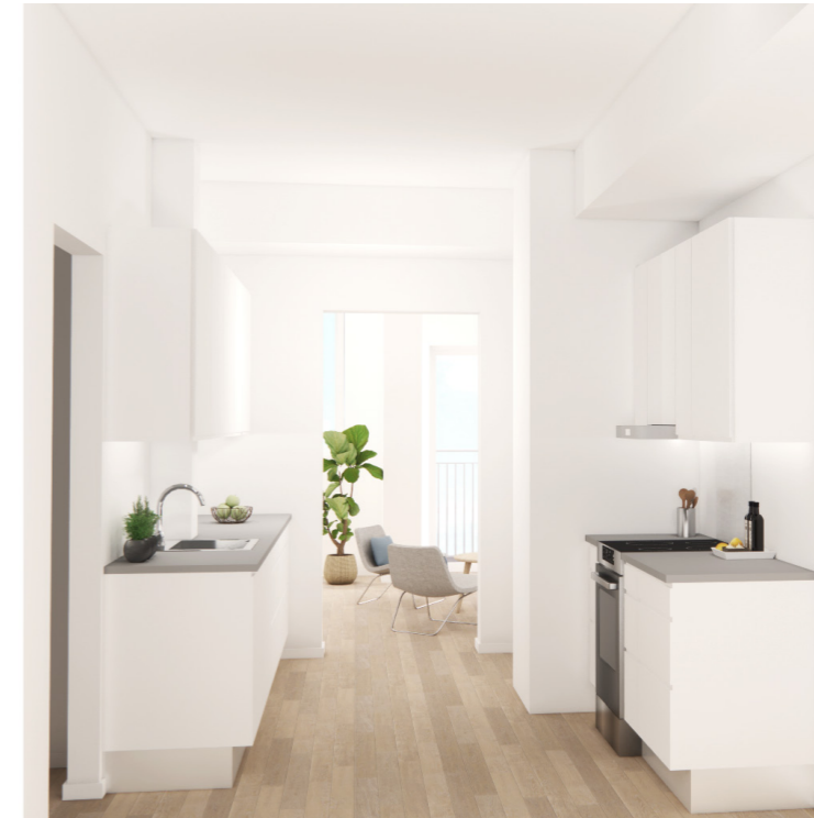
Køkkener i tilgængelighedsboligerne kan betjenes af en kørestolsbruger. Køkkenerne er ikke med hæve/sænke borde
