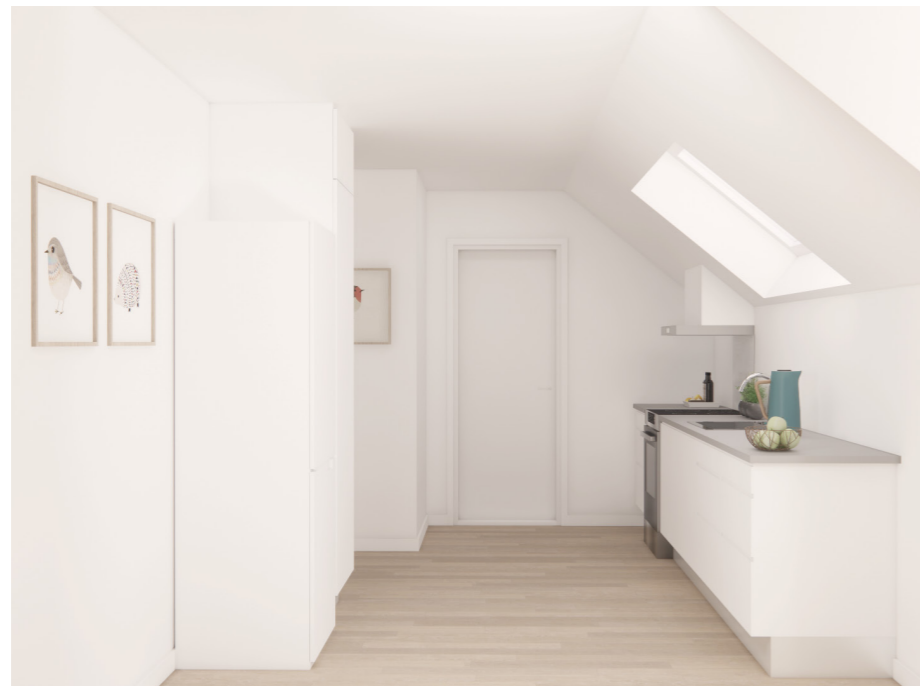
Indretning af køkkenerne i tagboligerne skal tage højde for det skrånende loft, hvorfor det skal sikres at der er fuld ståhøjde foran køkkenbordpladen.
